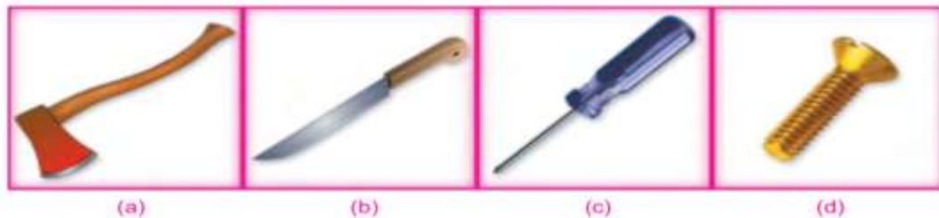
Gambar 7.9 Alat-alat yang menggunakan prinsip bidang miring, antara lain, (a) kampak, (b) pisau, (c) obeng, dan (d) sekrup
