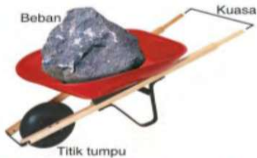
Gambar 7.6 Letak titik tumpu, beban, dan kuasa pada gerobak roda satu
