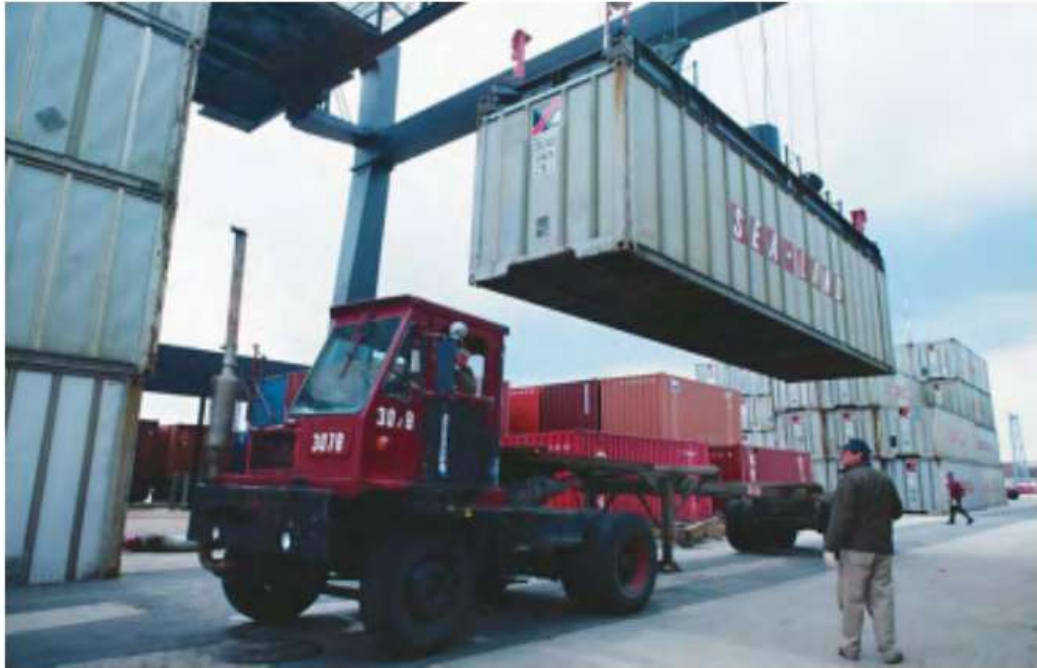
Gambar 7.12 Alat pengangkat peti kemas di pelabuhan menggunakan prinsip katrol bebas
