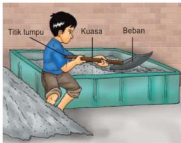
Gambar 7.7 Sekop adalah contoh tuas golongan ketiga
