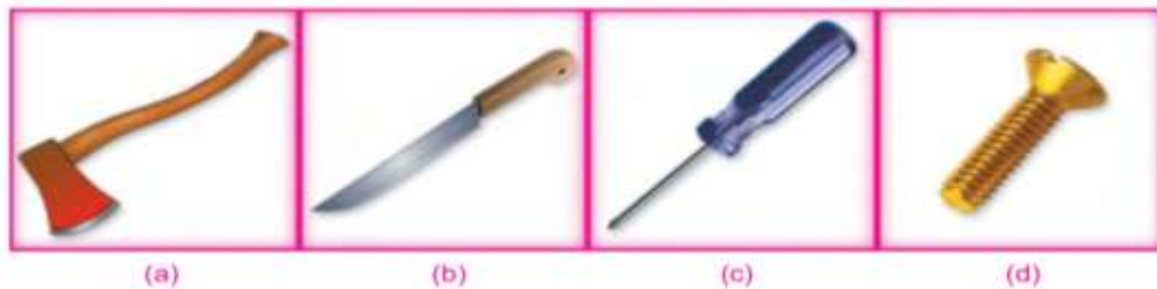
Gambar 7. 9 Alat-alat yang menggunakan prinsip bidang miring, antara lain, (a) kampak, (b) pisau, (c) obeng, dan (d) sekrup
