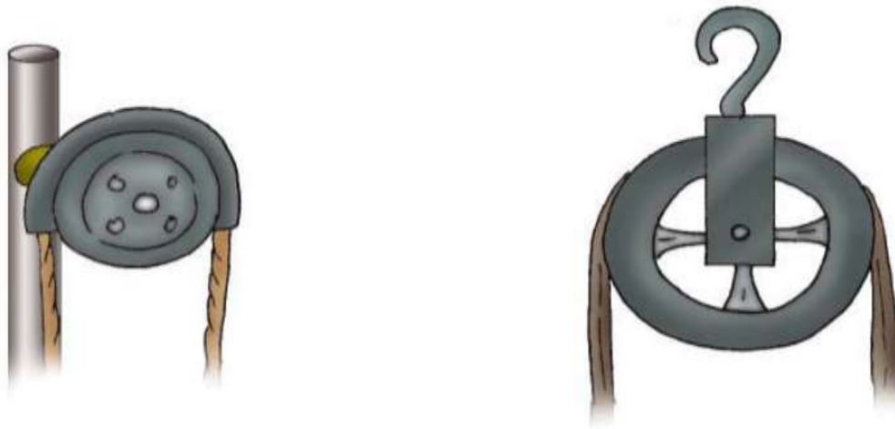
Gambar 7. 10 Contoh penggunaan katrol tetap: (a) katrol pada tiang bendera, (b) katrol pada sumur timba
