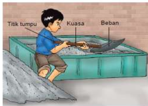
Gambar 1.11 sekop adalah contoh tuas golongan ketiga
