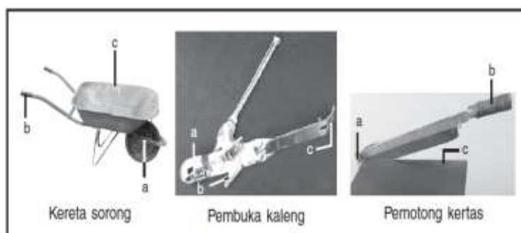
Gambar 1.9 letak titik tumpu, kuasa dan beban pada tuas golongan 2
