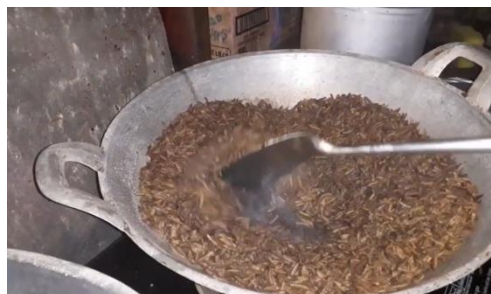
Gambar 1.1 Alat konvensional sangrai maggot yang masih digunakan
