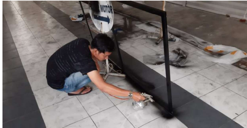
Gambar 3.10. Proses pengecatan rangka bilik.
