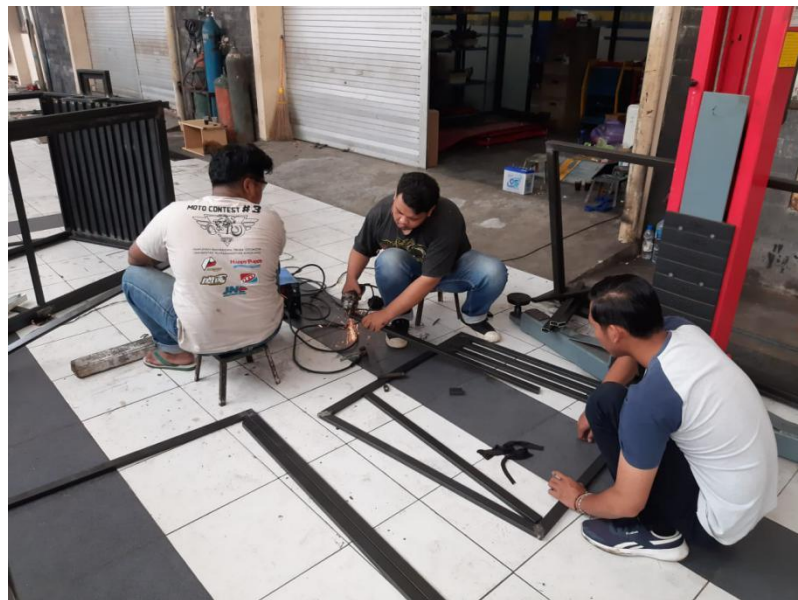
Gambar 3 9. Proses pemotongan besi sebagai rangka bilik
