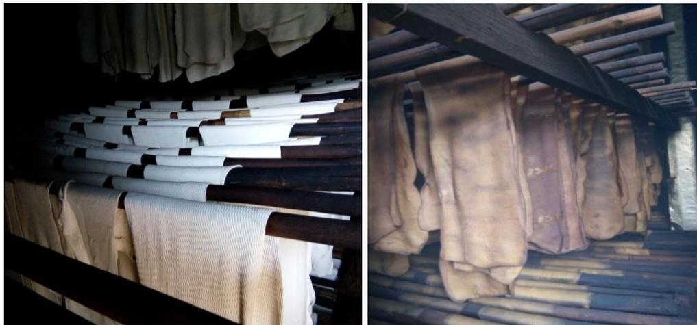
Gambar 2.5 Proses Pengasapan *Sheet* Basah
