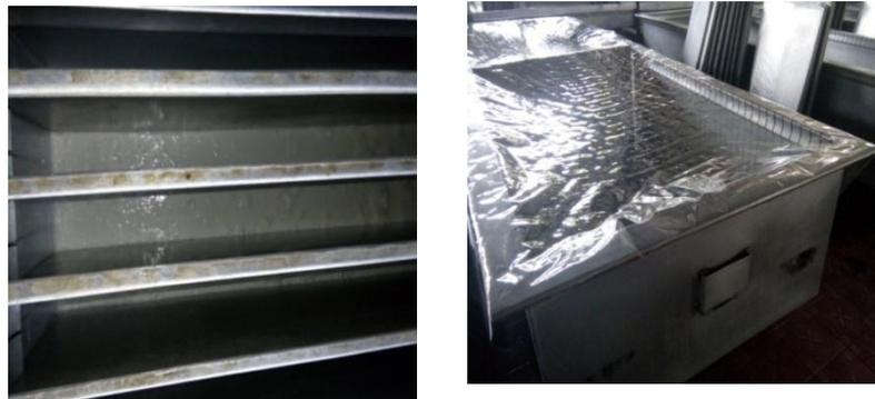
Gambar 2.3 Proses Penggumpalan atau Pembekuan *lateks* menjadi *slab*.
