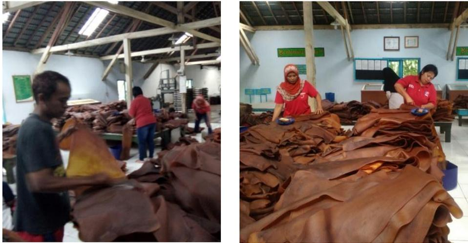
Gambar 2.6 Proses Sortasi *Sheet* Kering
