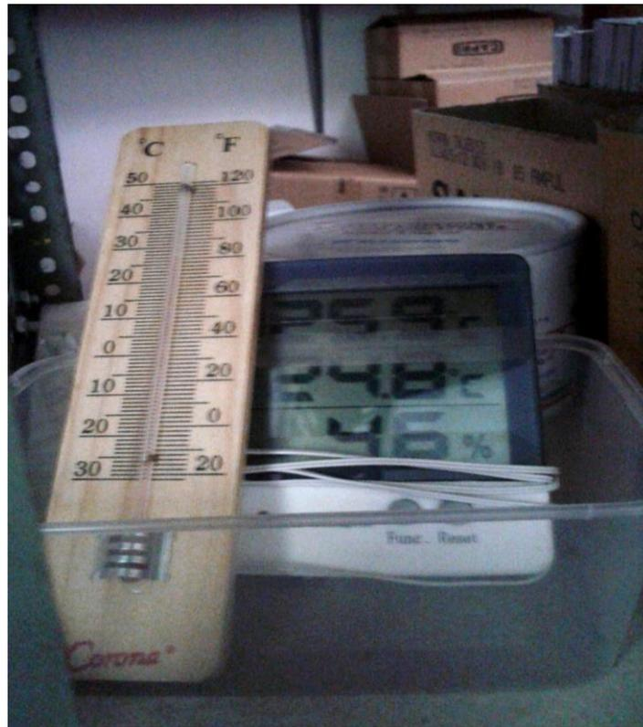
Gambar b. Thermometer dan Thermo-hygrometer
