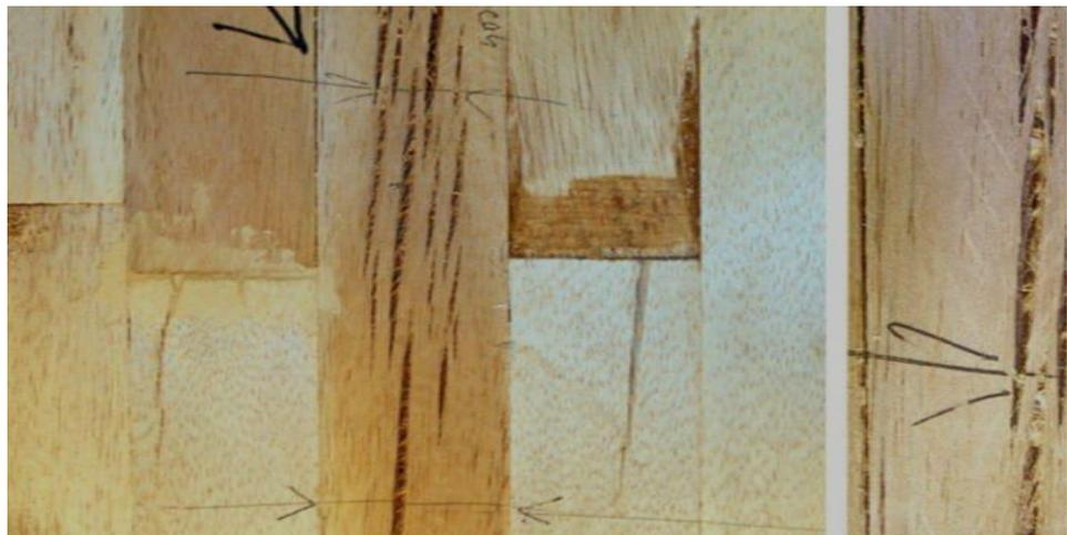
Gambar 2.2 Cacat pecah pada produk *barecore*
