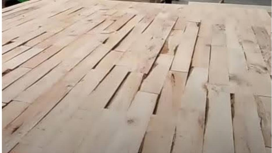
Gambar 2.3 Cacat *sanding* tidak rata pada produk *barecore*
