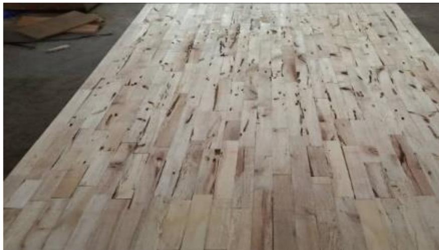
Gambar 2.4 Cacat berlubang pada produk *barecore*
