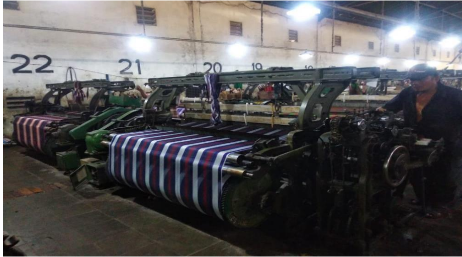
Gambar 2.10. Proses penenunan di mesin shuttle
