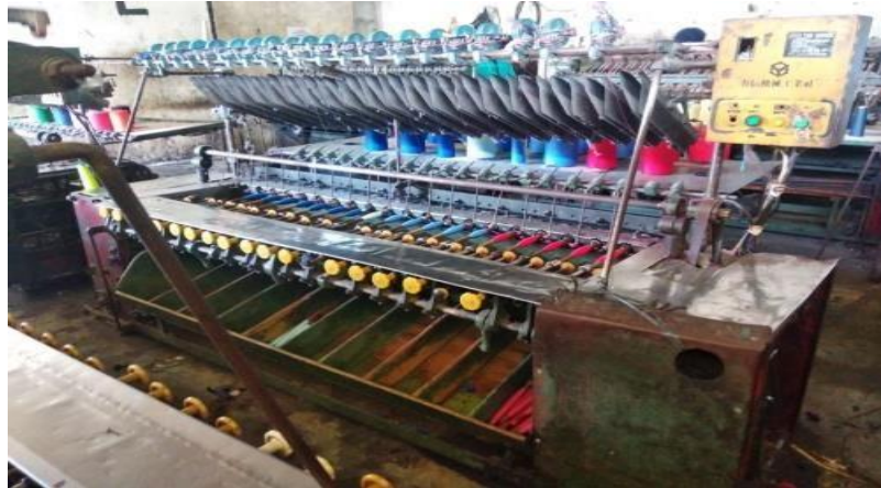
Gambar 2.6. proses pengulungan beam
