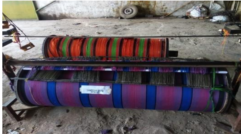
Gambar 2.7. proses memasukkan benang lusi pada droper
