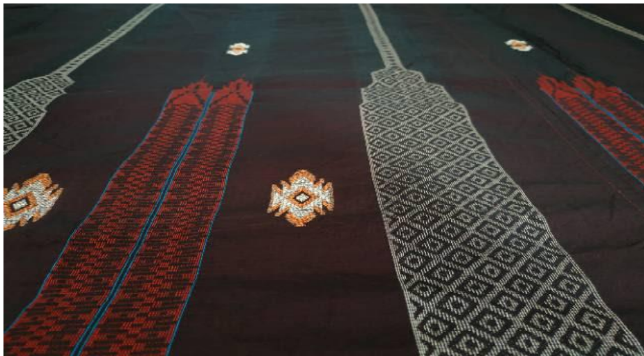
Gambar 2.1 kain sarung cacat double pakan
