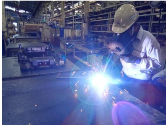
Gambar 2.9 Proses welding pada insert dies .
