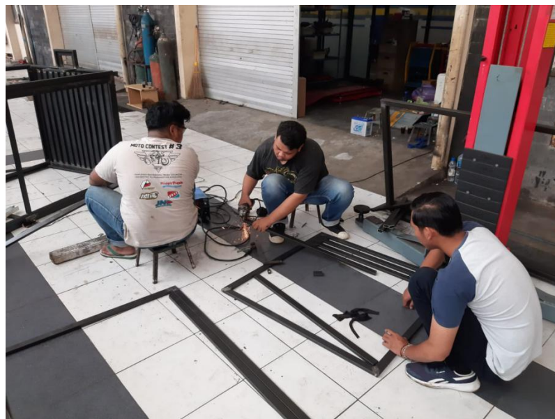
Gambar 3 9. Proses pemotongan besi sebagai rangka bilik
